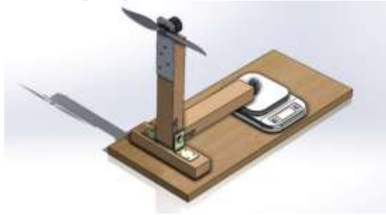
Şəkil 1. Fırçasız motorları test etmək üçün stendin sxemi və görünüşü
